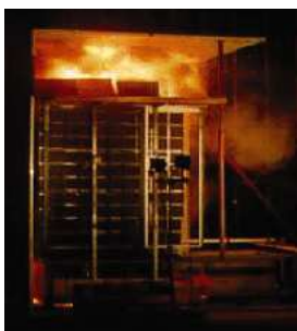
Essai d'arc interne
